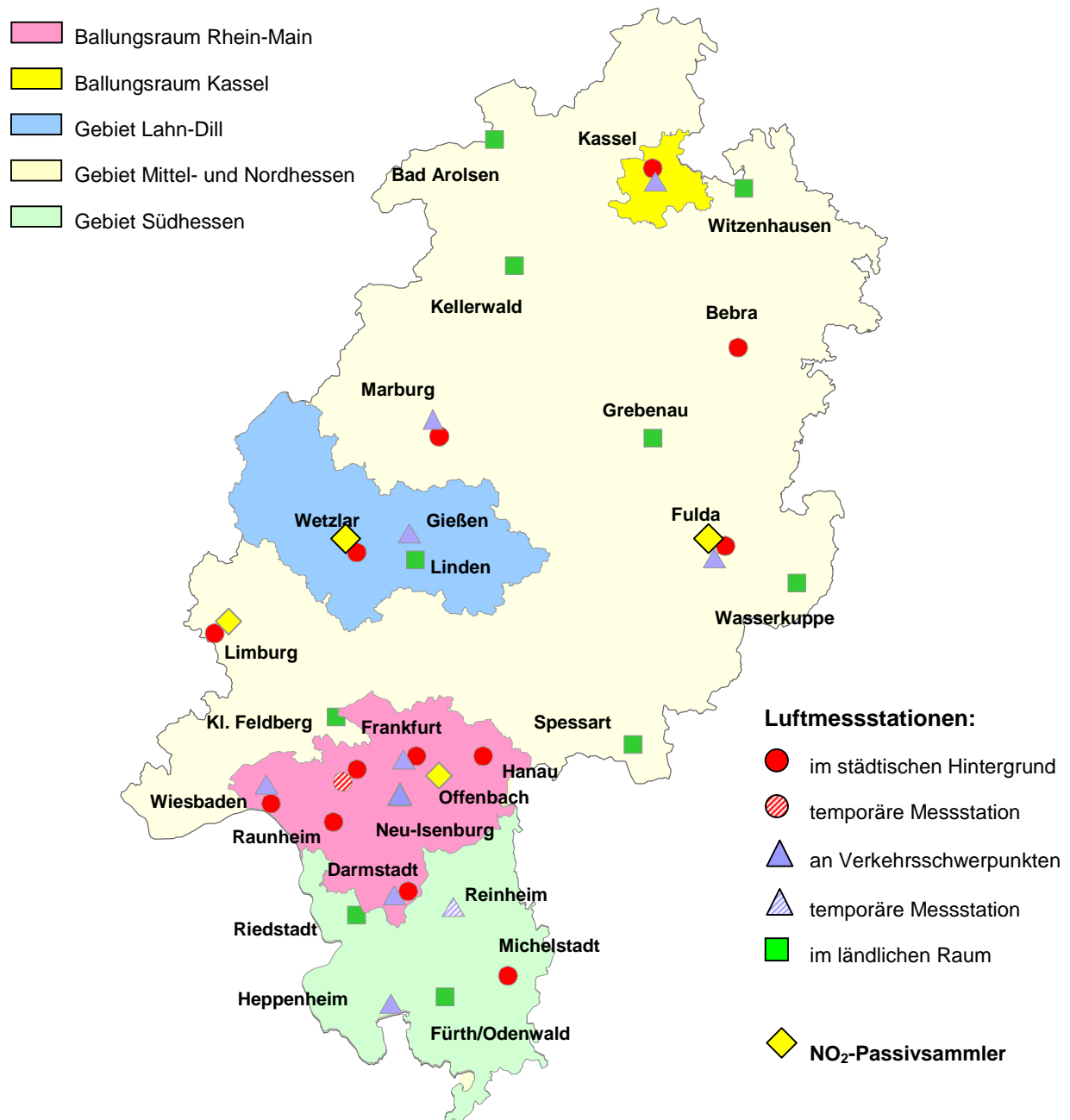
Abbildung 10: Luftmessstationen in Hessen (Stand: Januar 2009)
